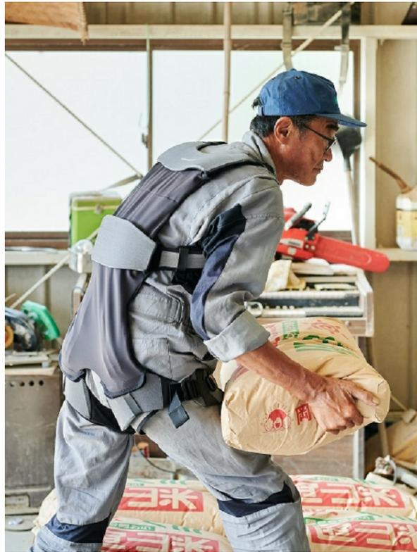
DARWING Hakobeludeはダイヤ工業独自の空気圧式の人工筋肉を用いることで持ち上げ作業をアシストします。長時間の中腰姿勢の保持もラクになる設計です。
