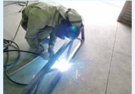
溶接による金属接合
